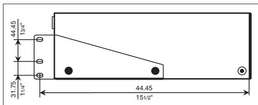
Beim Einbau in Gestellschränken sollen in jedem Fall Einbauschieben oder die beiliegenden Rackeinbauwinkel verwendet werden, um ein Verwinden der Frontblende zu verhindern.
